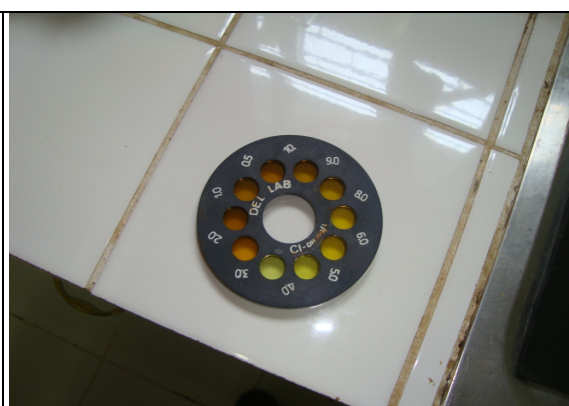
Foto 25 – Disco para medição do teor de cloro.
