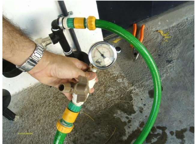
Foto 83 - Medição instantânea de pressão no endereço: Rua 22 de Maio, 126 - Menezes Pimentel.
