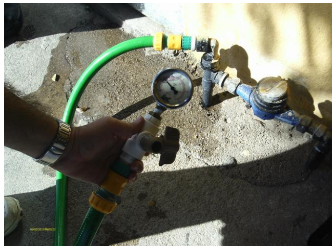
Foto 85 - Medição instantânea de pressão no endereço: Rua Pompeu Lira de Moraes, SMS 107 - Pereiras.
