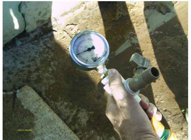
Foto 89 - Medição instantânea de pressão no endereço: Rua Aracajú, FNS 22 - Arco.
