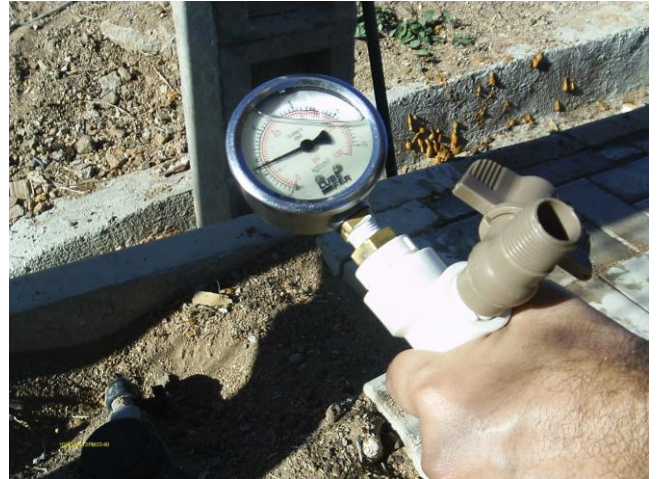
Foto 87 - Medição instantânea de pressão no endereço: Rua Melquíades Mourão, S/N - Boa Vida.
