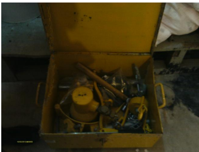
Foto 30 - Casa de química: Kit de emergência para cloro gasoso.
