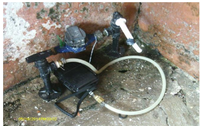
Foto 27 – Medição de pressão com instalação às 15:30h do dia 19/05/14 e retirada às 15:30h do dia 20/05/14, com aparelho datalogger na Rua Padre Heleno, nº 254.
