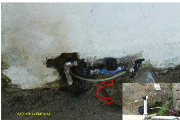
Foto 28 – Medição de pressão com instalação às 16:30h do dia 20/05/14 e retirada às 16:30h do dia 22/05/14, com aparelho datalogger na Rua Padre Tarcísio Melo (FNS 25).
