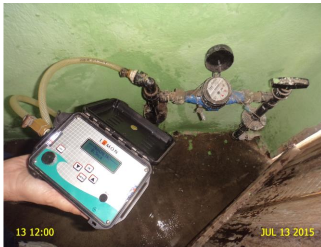
Foto 3 – Aparelho datalogger instalado no endereço localizado na Rua Luíz Rufino, nº 104.
