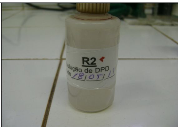
Foto 16 – Reagente químico DPD utilizado nas análises de cloro residual, com validade até 18/05/2011.
