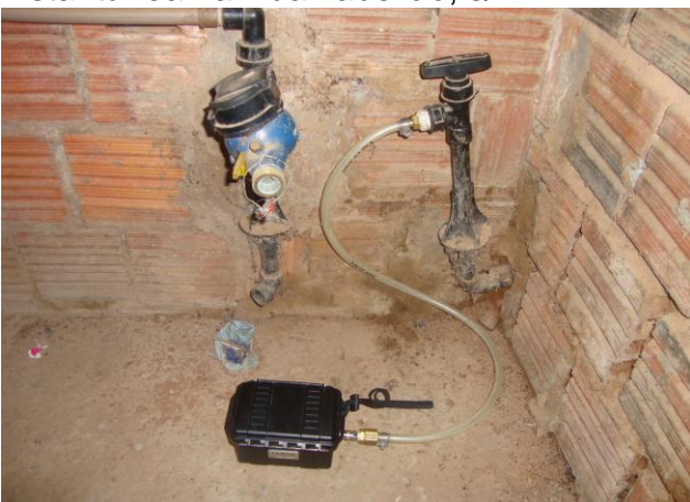
Foto 51 – Medição de pressão com instalação às 17:30h do dia 7/10/13 e retirada às 17:30h do dia 8/10/13, com aparelho datalogger na Rua SDO, nº 36 – Bairro Brasília.
