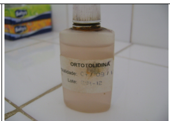
Foto 14 – Reagente químico Ortotolidina utilizado nas análises de cloro residual (dentro do prazo de validade – 7/9/2012).
