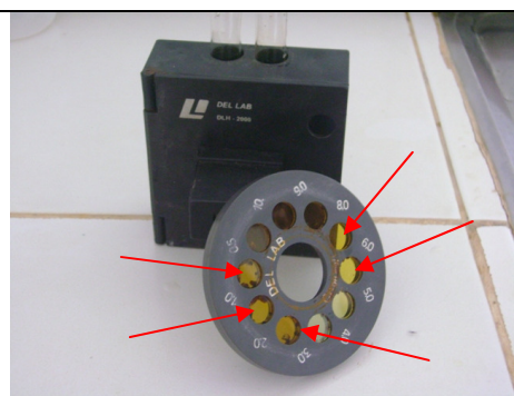
Foto 22 – Disco de cloro danificado
