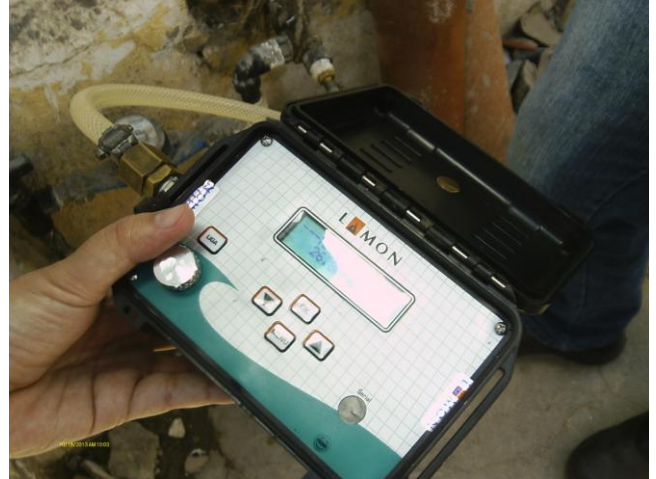
Foto 61 - Medição instantânea de pressão no endereço: Rua Alexandre Bonfim, 399.
