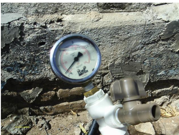
Foto 58 - Medição instantânea de pressão no endereço: Rua Emídio de Paula da Silva, 624 - Planalto.
