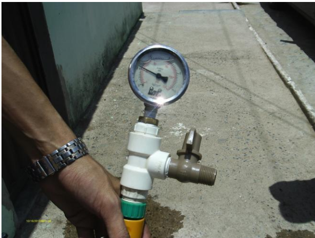
Foto 59 - Medição instantânea de pressão na rede de distribuição na rua Boa Esperança, VISA 15.
