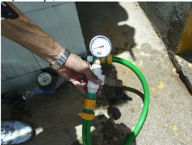
Foto 61 - Medição instantânea de pressã na rede de distribuição na Estrada para Fortaleza - VISA 3.
