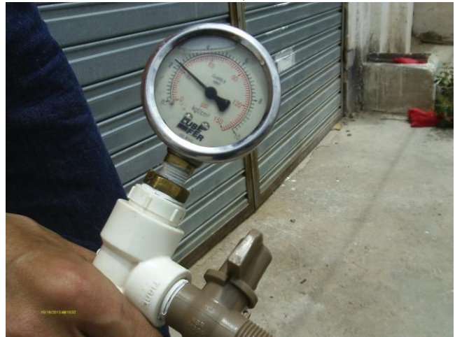
Foto 56 - Medição instantânea de pressão na rede de distribuição na Av. Jerônimo Alves - VISA 30.
