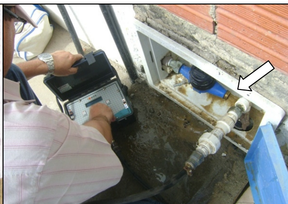
Foto 50 – Medição de pressão sem hidrômetro, na Rua Chico Cotinha, 105 – Centro.
