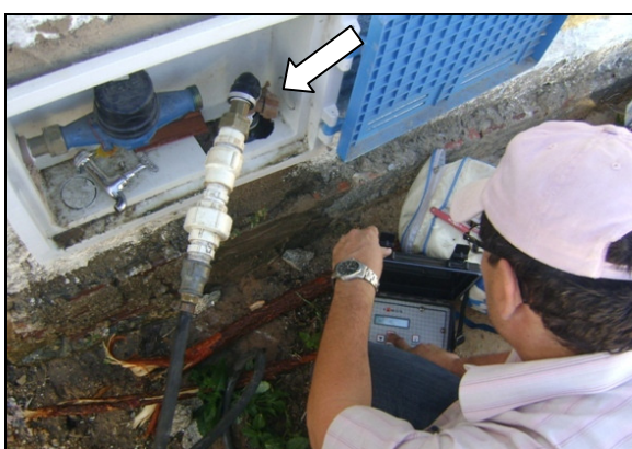
Foto 53 – Medição de pressão sem hidrômetro, na Rua Juvenal Silvano Alcântara II, Sítio Lucas.
