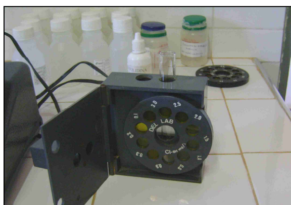
Foto 9 – Vista do Comparador de disco colorimétrico para cloro residual.
