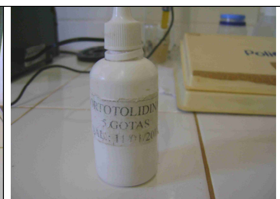
Foto 10 – Reagente químico Ortotolidina utilizado nas análises de cloro residual (dentro do prazo de validade – 11/01/2011).
