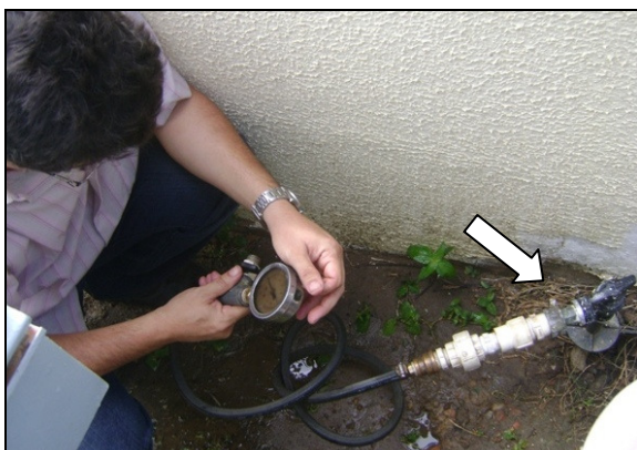
Foto 64 – Medição de pressão sem hidrômetro, na Travessa Felismino Filho, S/Nº - Várzea da Matriz (Fórum).
