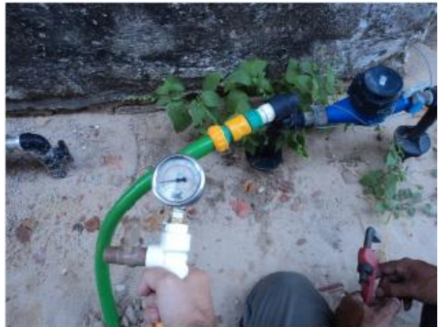
Foto 18 – Medição instantânea de pressão na R. Monte Mó, nº 671 – Bairro Cruz das Almas.
