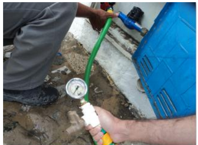
Foto 16 – Medição instantânea de pressão na R. Caboclo Nogueira, nº 40 (Creche) – Centro.
