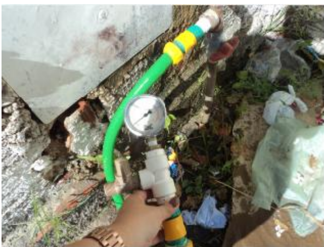
Foto 21 – Medição instantânea de pressão na R. José dos Santos Girão (E.E.F. Alice Fernandes Lopes).
