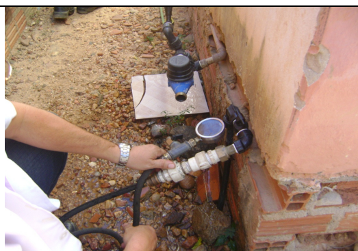
Foto 73 – RDA: medição de pressão no endereço Rua E, 3 - Conjunto Habitar - São Benedito.
