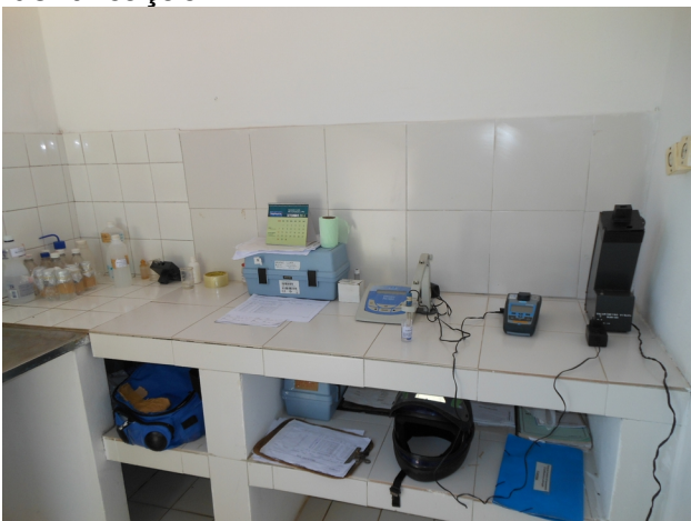
Foto 17 - Laboratório: equipamentos para análise de cor, turbidez e pH.
