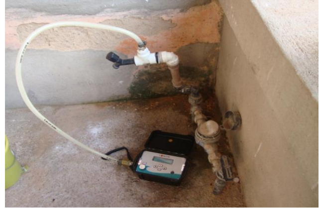
Foto 43 – Medição de pressão com instalação às 14:30h do dia 11/11/13 e retirada às 14:30h do dia 12/11/13, com aparelho datalogger na Rua João Pessoa, nº 10 (FNS).
