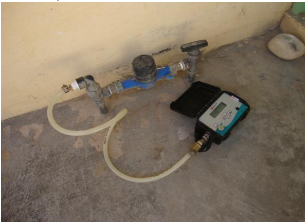
Foto 37 – Medição de pressão com instalação às 11:30h do dia 12/11/13 e retirada às 11:30h do dia 13/11/13, com aparelho datalogger na Rua Central, s/n.
