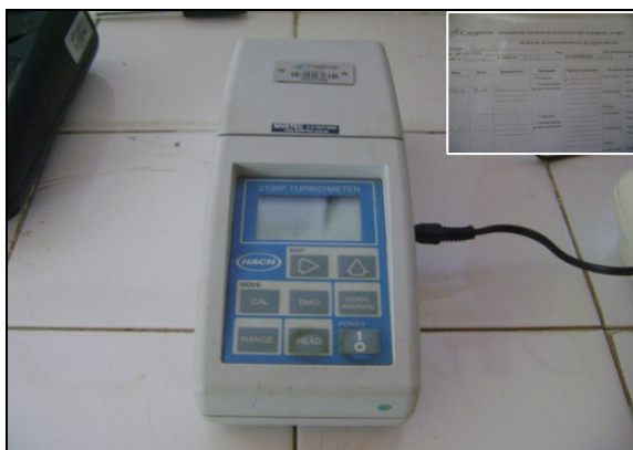
Foto 12 – Turbidímetro e ficha de controle de calibração do equipamento.
