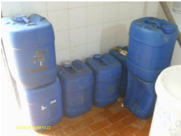
Foto 4 - Polímero armazenado em contato direto com o chão e sem etiqueta com data de validade.
