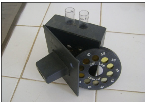
Foto 16 – Colorímetro e discos comparadores de cloro.
