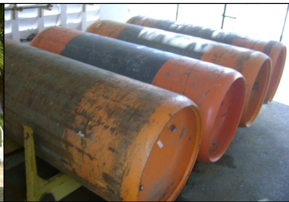
Foto 30 – Cilindros de cloro gasoso.
