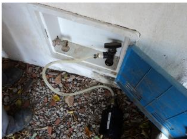
Foto 50 – Rede de distribuição: medição contínua de pressão na Av. Migueira Braga.
