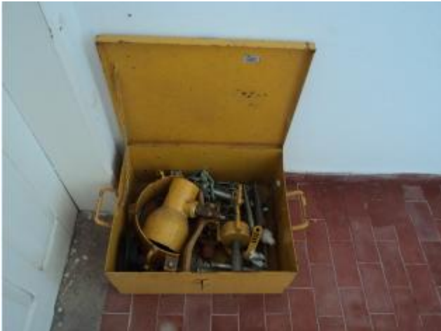
Foto 23 – Casa de química: kit de emergência de cloro gasoso.
