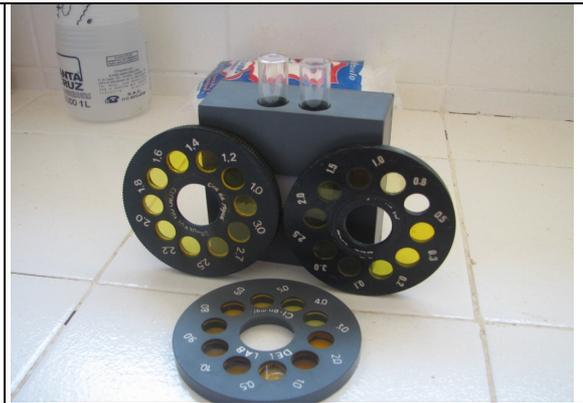
**Foto 21** – Laboratório - disco para medição do teor de cloro.
