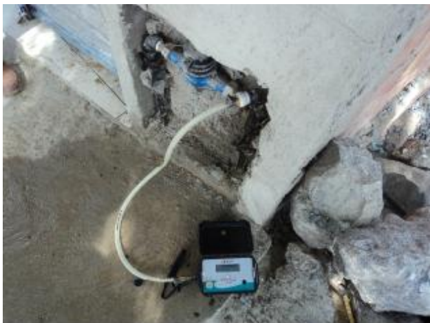
Foto 65 – Rede de distribuição: medição instantânea de pressão na Rua 7 de Setembro, S/N.
