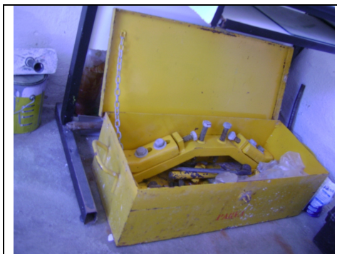
Foto 19 – Kit de emergência para vazamento de cloro gasoso.
