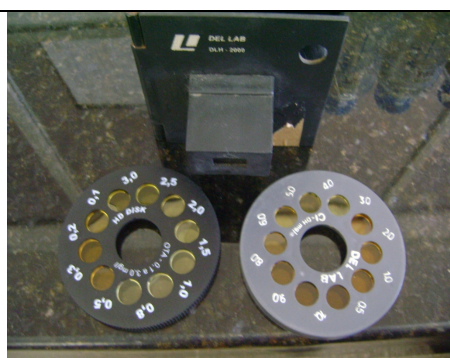
Foto 17 – Discos comparadores utilizados para a medição de cloro com valores máximos de 3,0 e 10,0 mg/L.
