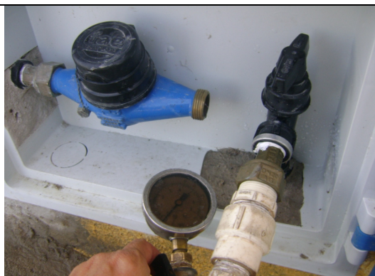
Foto 71 – RDA: medição de pressão no endereço Avenida Jesus, Maria e José, 2.495 - Nova Aldeota.
