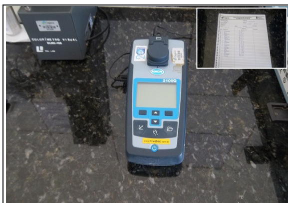
Foto 17 – Turbidímetro e ficha de controle de calibração do equipamento.
