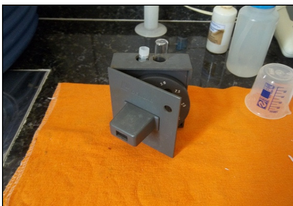
Foto 15 – Vista do Comparador de disco colorimétrico para cloro residual.
