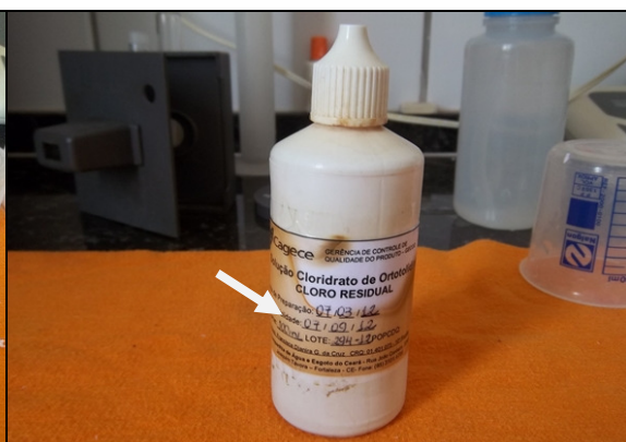
Foto 16 – Reagente químico Ortotolidina utilizado nas análises de cloro residual (prazo de validade vencido – 7/9/2012).
