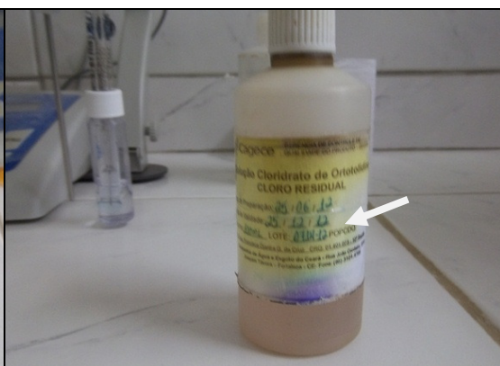
Foto 12 – Reagente químico Ortotolidina utilizado nas análises de cloro residual (prazo de validade – 25/12/2012).
