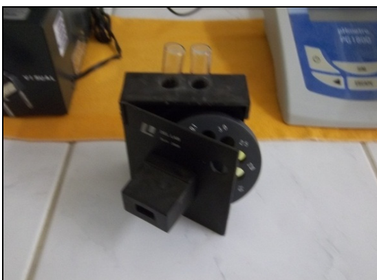
Foto 11 – Vista do Comparador de disco colorimétrico para cloro residual.
