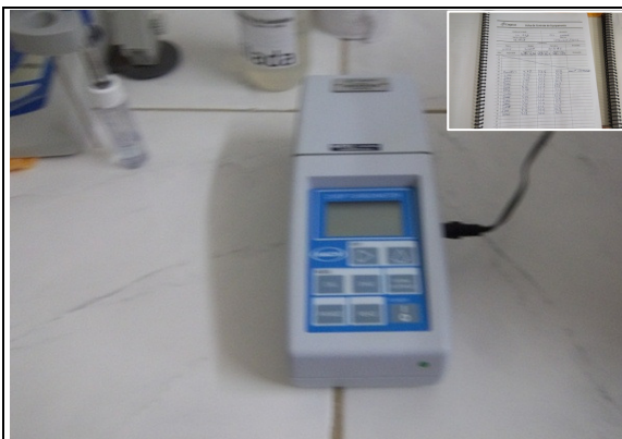
Foto 13 – Turbidímetro e ficha de controle de calibração do equipamento.
