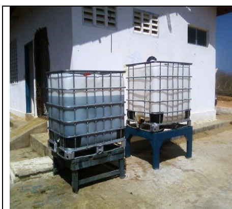
Foto 10 – Armazenamento inadequado de produtos químicos
