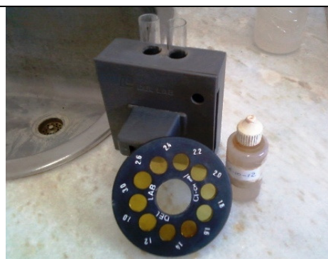
Foto 18 – Disco de cloro com valor máximo de 3,0mg/l
