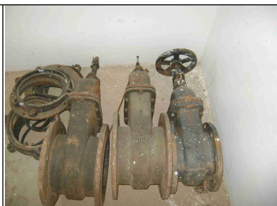
Foto 8 – Registros existentes na ETA, destinados à substituição dos registros de lavagem dos filtros.
