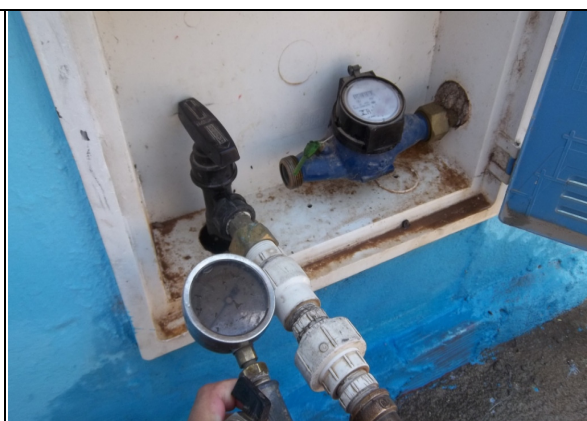
Foto 24 – RDA: medição de pressão no endereço Conjunto Euclides, 18 (FNS).
