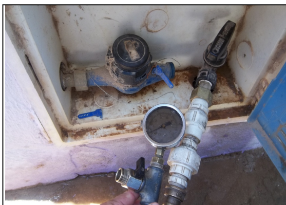
Foto 23 – RDA: medição de pressão no endereço Estrada para Breguedorff.
