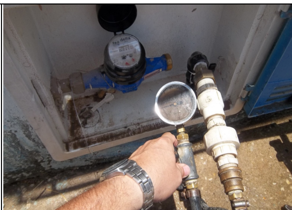
Foto 26 – RDA: medição de pressão no endereço Av. Bernadone Teles, 60 (FNS), saída para Sobral.
