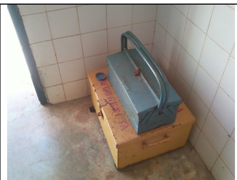
Foto 19 – Kit de emergência para vazamento de cloro gasoso.
