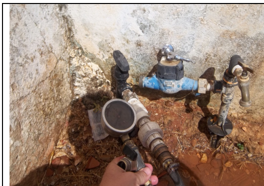
Foto 62 – RDA: medição de pressão no endereço Avenida Rafael de Abreu – E.E.F. Elber Aguiar.
