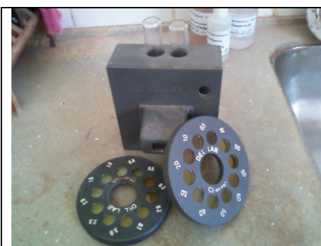
Foto 16 – Discos comparadores utilizados para a medição de cloro com valores máximos de 3,0 e 10,0 mg/L.
