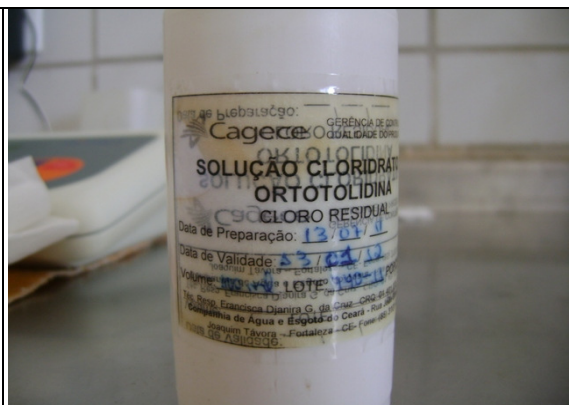
Fotos 12 – Reagente químico Ortotolidina utilizado nas análises de cloro residual (dentro do prazo de validade – 13/01/2012).
