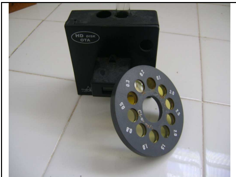
Foto 32 – Disco de cloro com valor máximo de 3,0mg/l.
