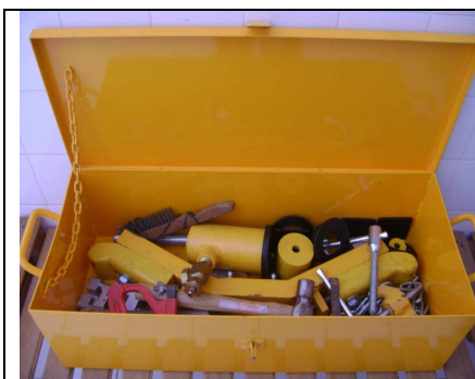
Foto 28 – Kit de emergência para cloro gasoso, armazenado no almoarifado.
