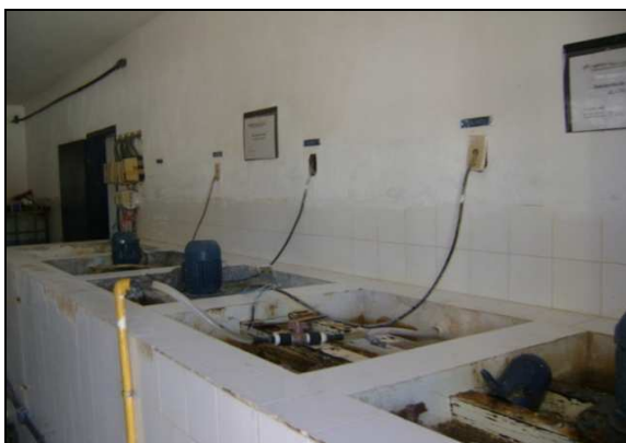
Foto 24 – Tanques de mistura.
