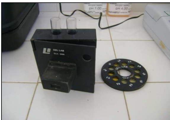
Fotos 16 – Vista do Comparador de disco colorimétrico para cloro residual.
