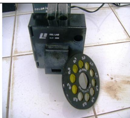
**Foto 22** – Disco de cloro com valor máximo de 3,0mg/l
