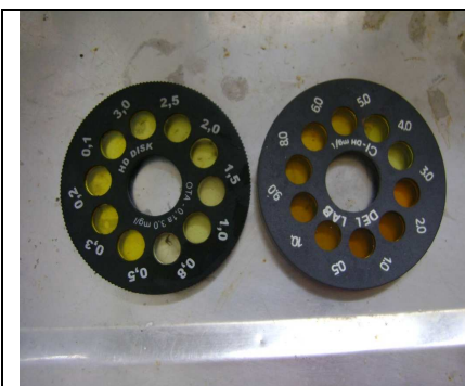
Foto 45 – Disco comparador de cloro com valor máximo de 3,0 e 10 mg/l.
