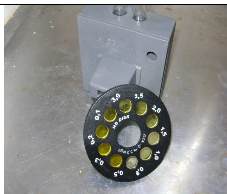
Foto 44 – Disco comparador de cloro com valor máximo de 3,0 mg/l.
