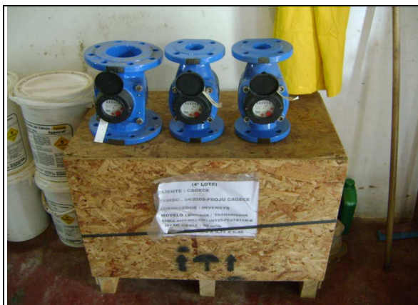
Foto 82 – Macromedidores a serem instalados no SAA de Palmácia.
