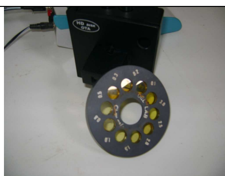
Foto 27 – Disco comparador de cloro com valor máximo de 3,0 mg/l.
