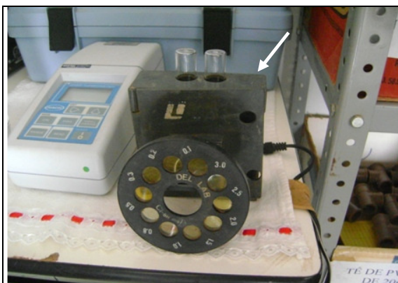
Foto 7 – Vista do Comparador de disco colorimétrico para cloro residual.
