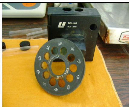
Foto 20 – Disco de cloro com valor máximo de 10,0mg/l
