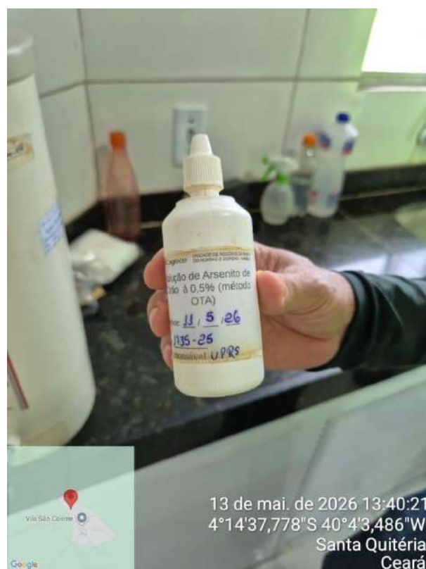
Foto 74 - ETA / Casa de química (sede): solução de arsenito de sódio vencida.
