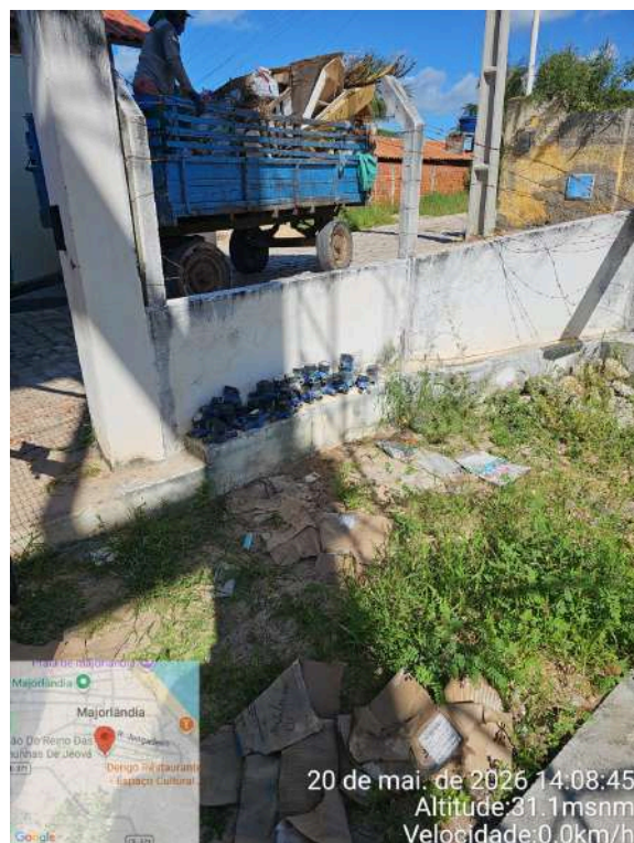
Foto 209 - REL-01 (Majorlândia): hidrômetros armazenados inadequadamente.
