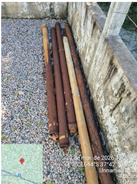
Foto 240 - PT-02 (Majorlândia): tubulações oxidadas armazenadas na EEAT-02.
