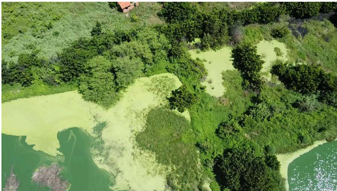
Foto 296 - ETE Canoa Quebrada: região ao lado do leito de secagem com transbordo.
