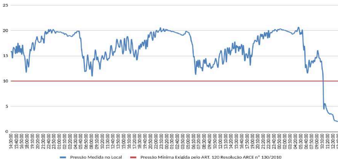
Figura 2 - Monitoramento da pressão no SAA de Catunda, realizada pela ARCE na Rua Prefeito Ernane Lima, s/n CEP 62.297-000, período de 29/09/2025 a 02/10/2025.
