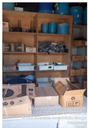
Foto 82 - Almoxarifado (ETA-02) (Sede): sem iluminação; materiais armazenados de forma precária, sem organização e controle; área destinada à armazenagem de produtos químicos, utilizadas para guardar outros materiais
