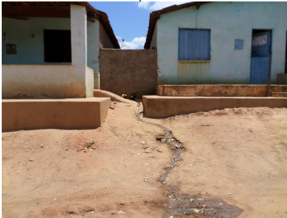
Figura 6.22: Efluentes domésticos sendo lançado a céu aberto no Distrito de Assunção
