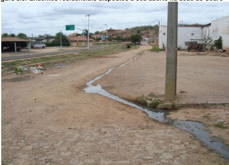
Figura 8.3: Efluentes residenciais dispostos a céu aberto na sede de Cedro
