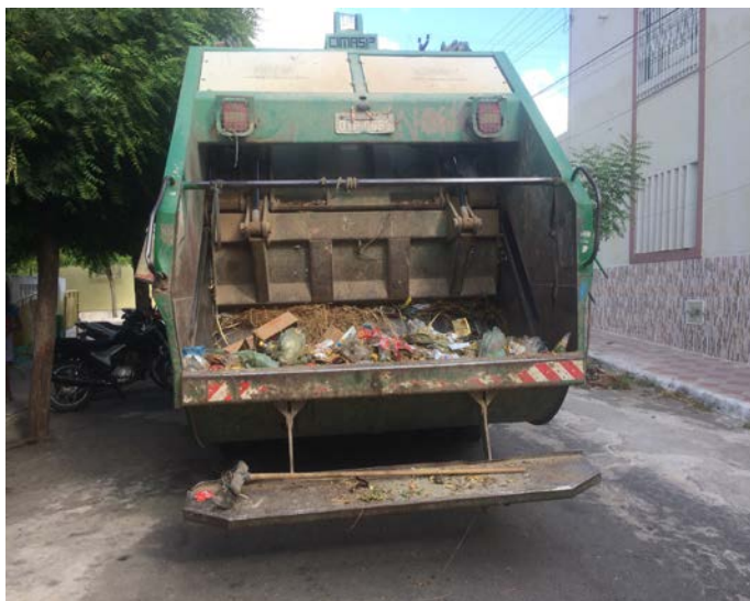
Figura 4.5 - Veículo de coleta, caminhão compactador.
