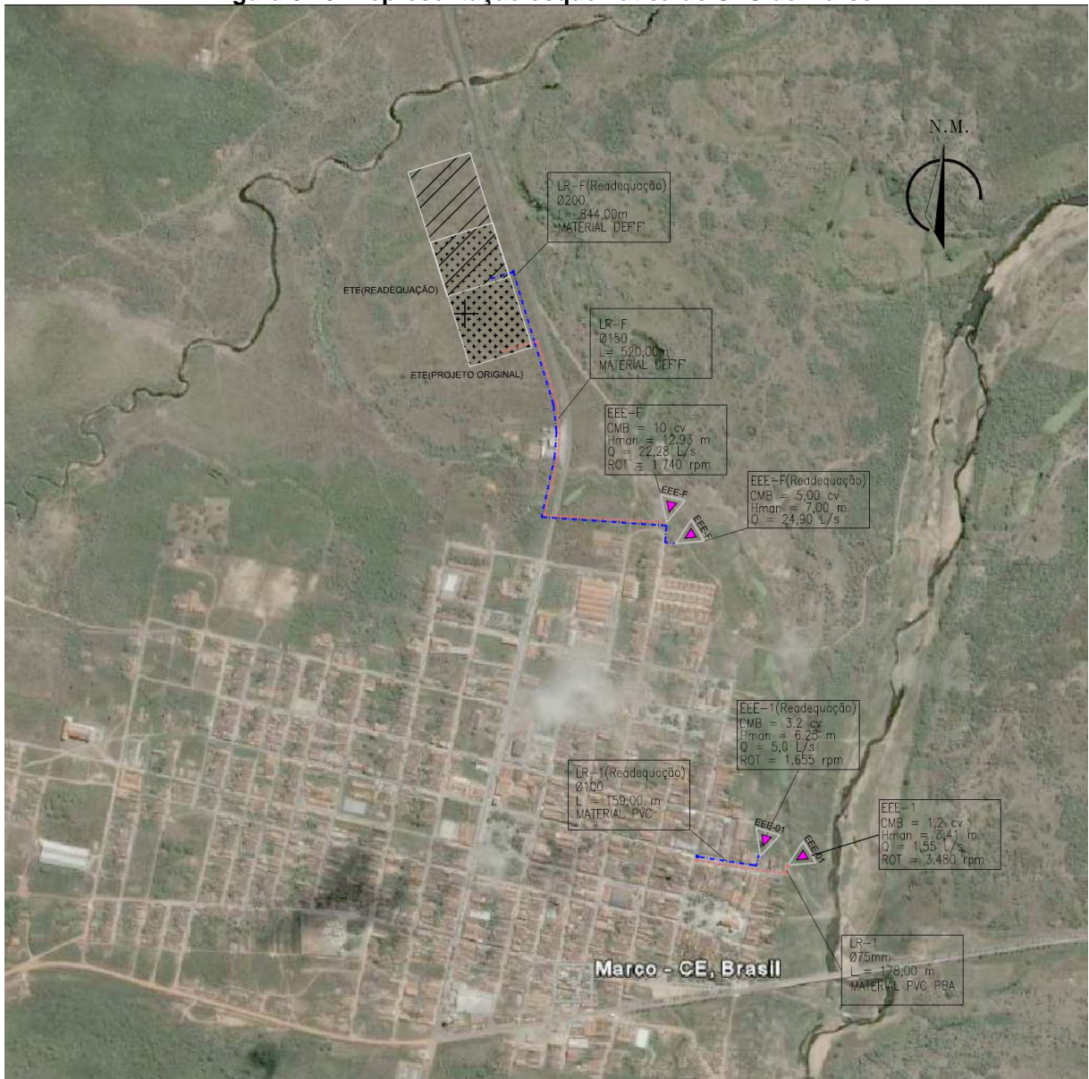
Figura 5.13: Representação esquemática do SES de Marco.
