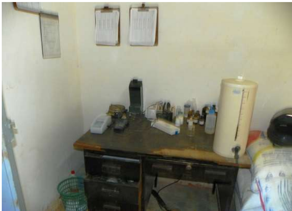
Figura 7.13 – Vista dos equipamentos pHmetro, turbidímetro e colorímetro existentes na Estação de Tratamento de Água (ETA) da sede de Farias Brito.
