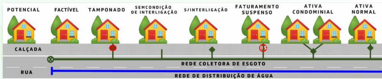
Figura 2: Situações de Ligação de Esgoto
