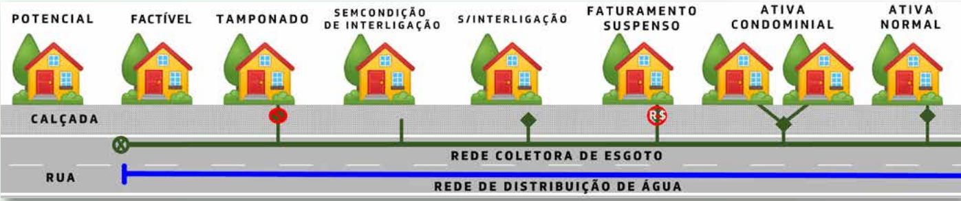
Figura 2: Situações de Ligação de Esgoto
