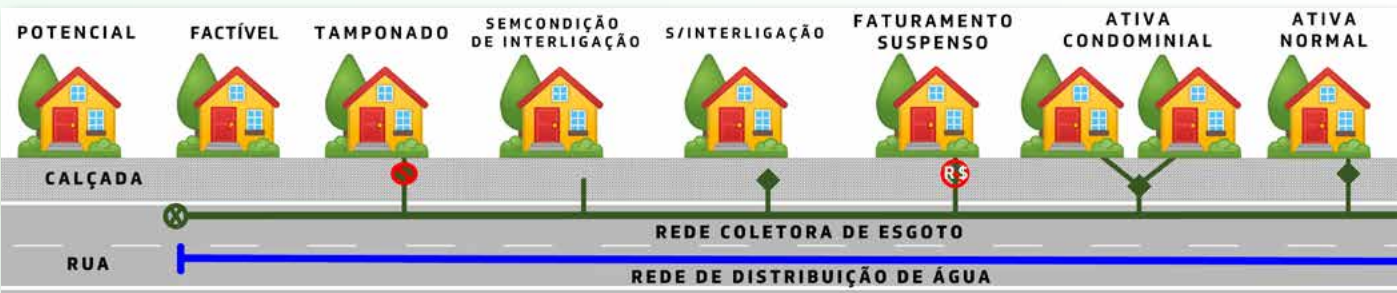
Figura 2: Situações de Ligação de Esgoto
